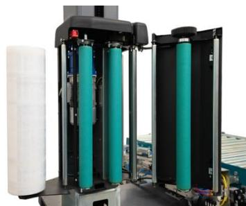
Бобина с пленкой высотой 500 мм, максимальным внешним диаметром 250 мм и максимальным весом 20 кг.
